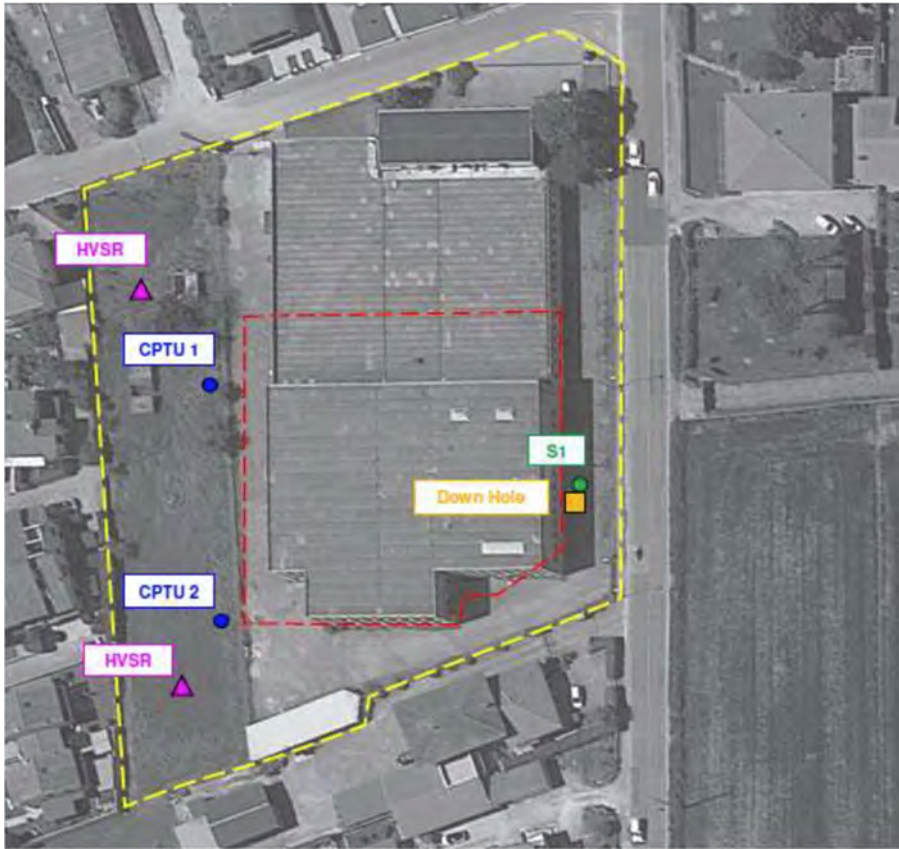
AVOLA 1. Estratto di ortofoto dell'area di intervento, con indicazione del perimetro di proprietà (tratteggio giallo) all'area di sedime del nuovo centro commerciale (tratteggio rosso) unitamente all'ubicazione delle indagini sognostiche eseguite.
